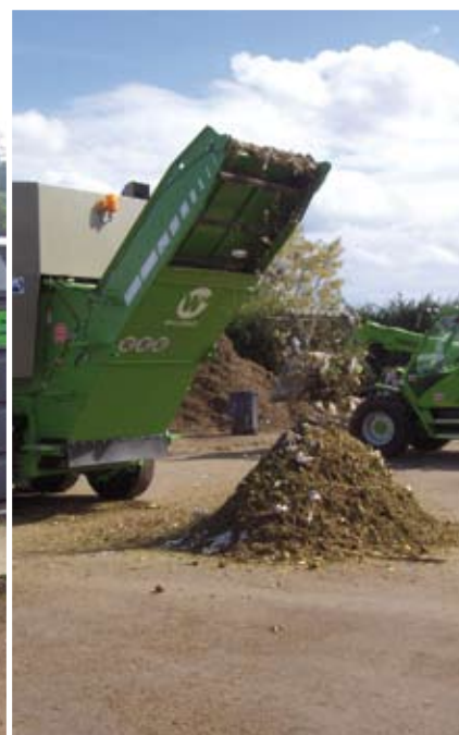
Broyage des bio-déchets
