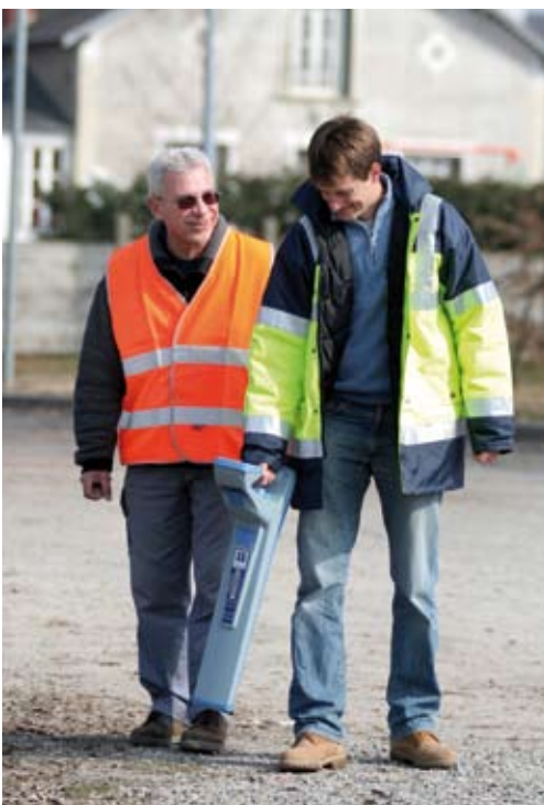
Détection de câbles
